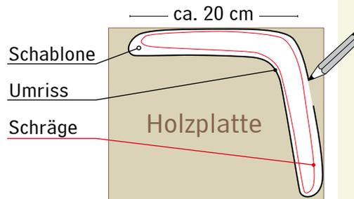
Zeichne die Form des Bumerangs auf festes Papier und schneide diese sauber aus. Es wird deine Schablone, eine Art "Lineal", mit der du später den Umriss auf die Holzplatte überträgst.
